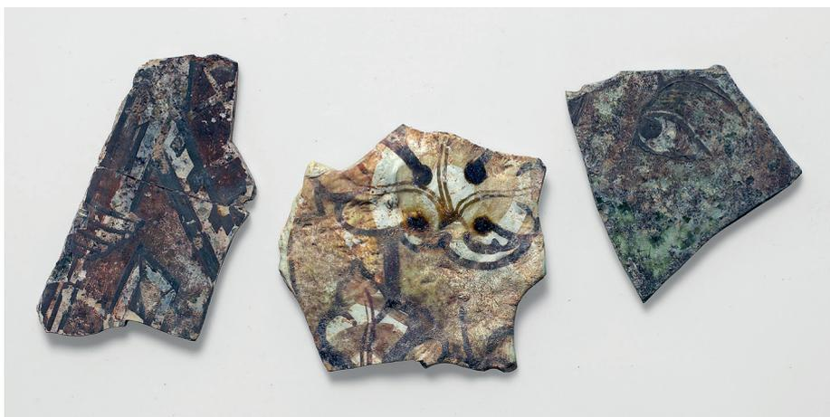
17. Vitraux médiévaux endommagés suite à un incendie. Un fixage des surfaces, accompagné d'un nettoyage prudent ont ravivé les traits de grisaille : on distingue des éléments d'architecture, le museau d'un animal et l'œil gauche d'un personnage.
