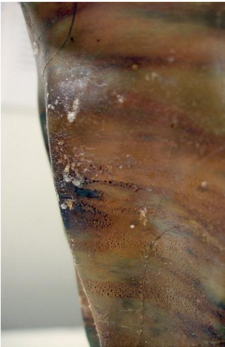
18. Suite à une très forte et rapide augmentation d'humidité, des efflorescences blanchâtres ont recouvert la corolle de cette fleur Art Nouveau. Il s'agit de formate de soude sous forme cristalline. Ce verre est fragilisé. Il doit être nettoyé et conservé dans une atmosphère sèche et stable. Son état doit être contrôlé régulièrement.
