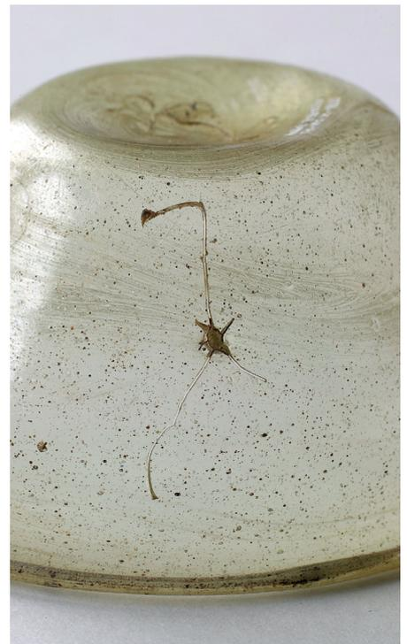
3. Sur la paroi de cette coupe mérovingienne, la dissolution d'une matière mal ou non vitrifiée (inclusions parasites) s'est soldée par un vide localisé, à la façon d'une galerie de ver de terre.
